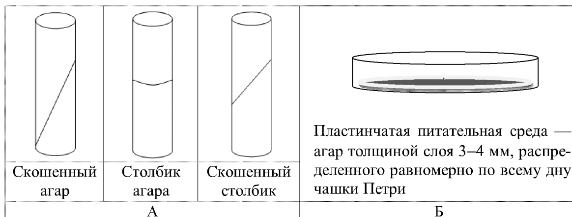
Рисунок 11 — Варианты разлива плотной питательной среды (агара): А — в пробирке; Б — в чашке Петри
