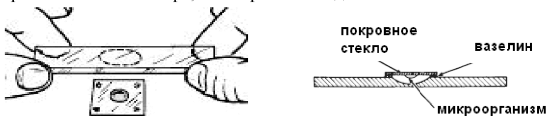
Рисунок 4 — Схема приготовления препарата «висячая капля»
