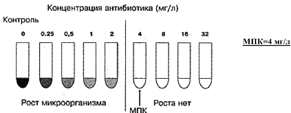
Рисунок 31 — Определение значения минимальной подавляющей концентрации методом разведения в жидкой питательной среде
